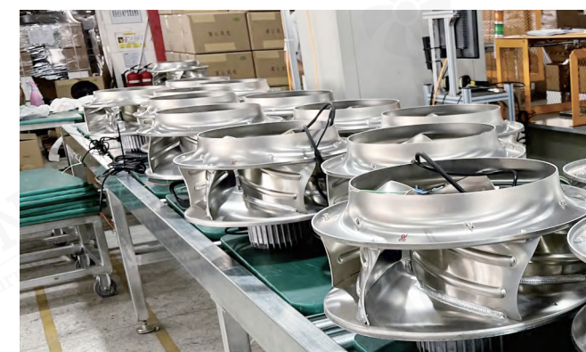
Production Line - Centrifugal Fan
