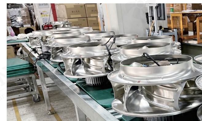
Production Line - Centrifugal Fan
